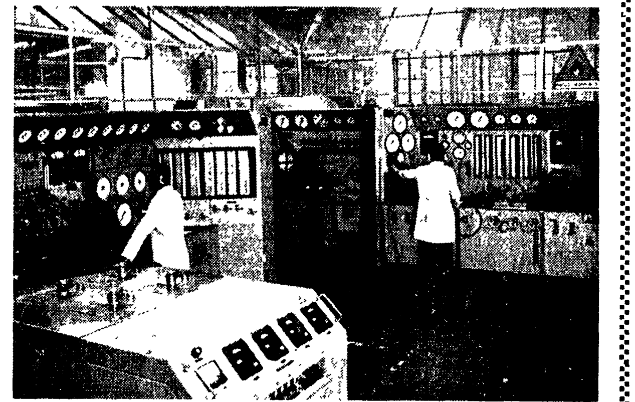
Uno dei banchi prova per le pompe benzina dei motori per aeroplani civili nello stabilimento Alfa Romeo di Pomigliano d'Arco.
