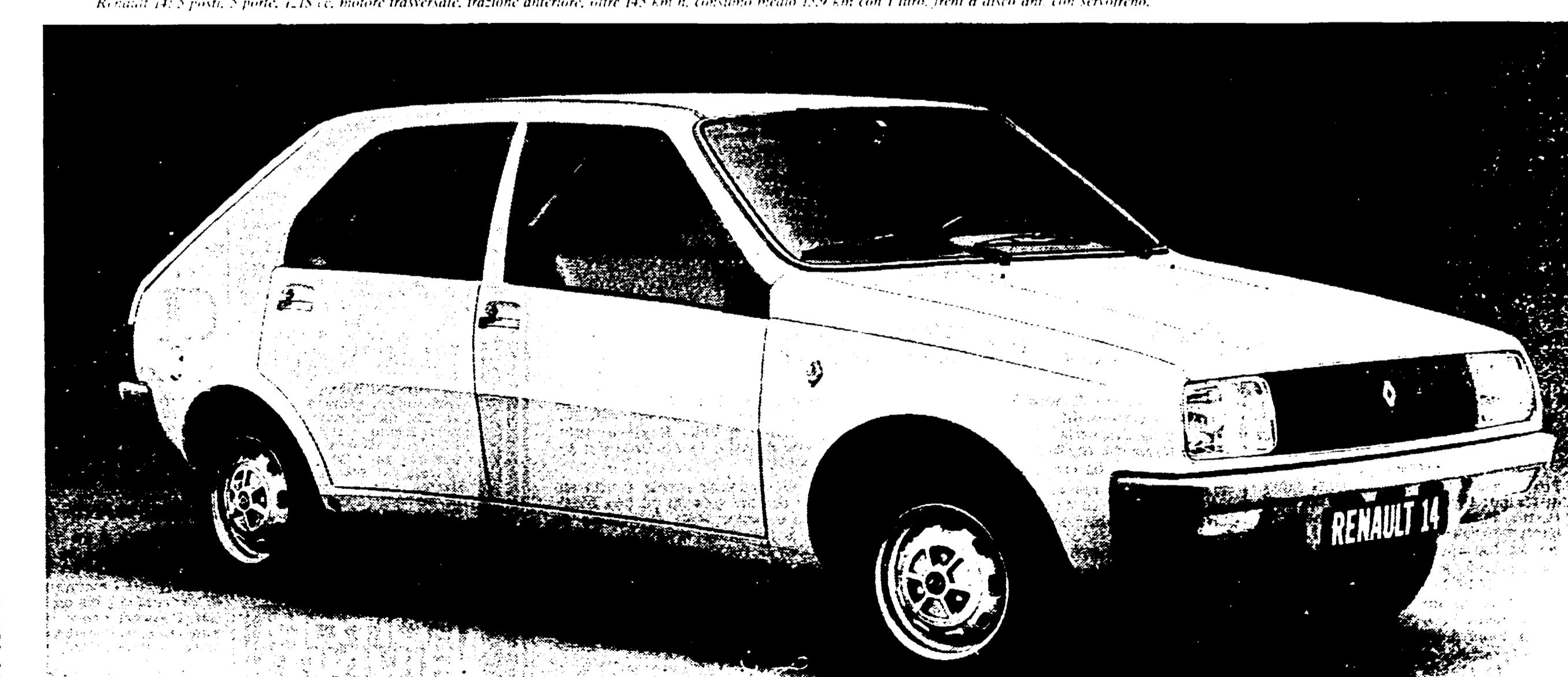
Renault 14: 5 posti, 5 porte, 1218 cc, motore trasversale, trazione anteriore, oltre 145 km/h, consumo medio 15,9 km con 1 litro, freni a disco ant. con servofreno.
