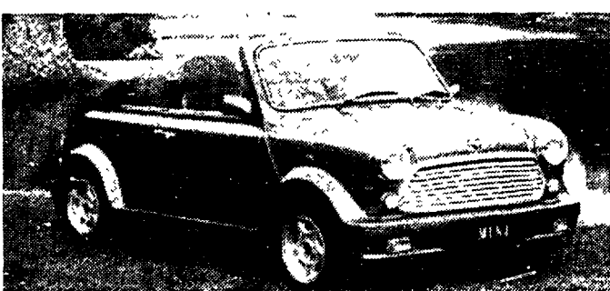
La Mini Cabriolet, ultima versione dell'intramontabile vettura britannica, è mossa dal brillante quattro cilindri di 1275 cc e 63 cv derivato dal motore della leggendaria «Cooper».
