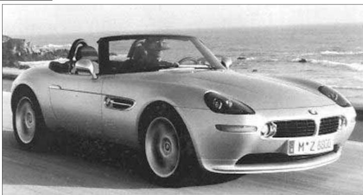
erogano 400 cavalli. La velocità? Un brivido da 250 chilometri all'ora. In 5 secondi la Z8 passa da 0 a 100 km/h. La Z8 impiega 2,5 secondi per frenare da 100 a 0 km/h. La trazione è posteriore, il cambio a sei marce. Di serie i cerchi in lega da 18 pollici ospitano pneumatici 245/45 anteriormente e da 275/40 nel posteriore. Sempre di serie il sistema di controllo della stabilità DSC III, ottimo per i piloti meno esperti e comodo per chi è alla ricerca di una guida-relax.
