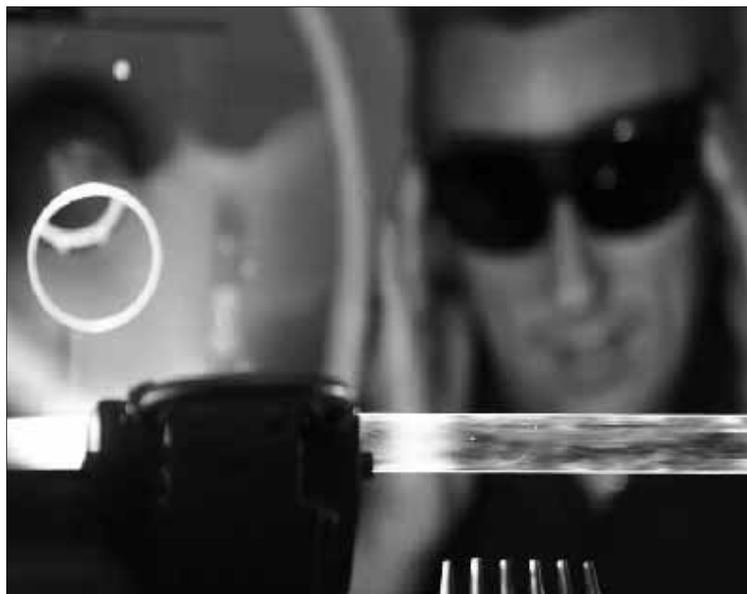
Un fascio di luce corre in una fibra ottica
