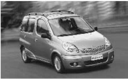
1.4 D-4D common-rail da 75 CV e 170 Nm di coppia massima a 2000 giri, che pur garantendo una velocità massima di 160 km/h è accreditato di un
