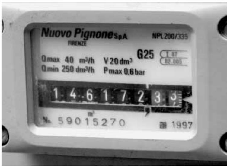
Il quadrante di un contatore del gas
