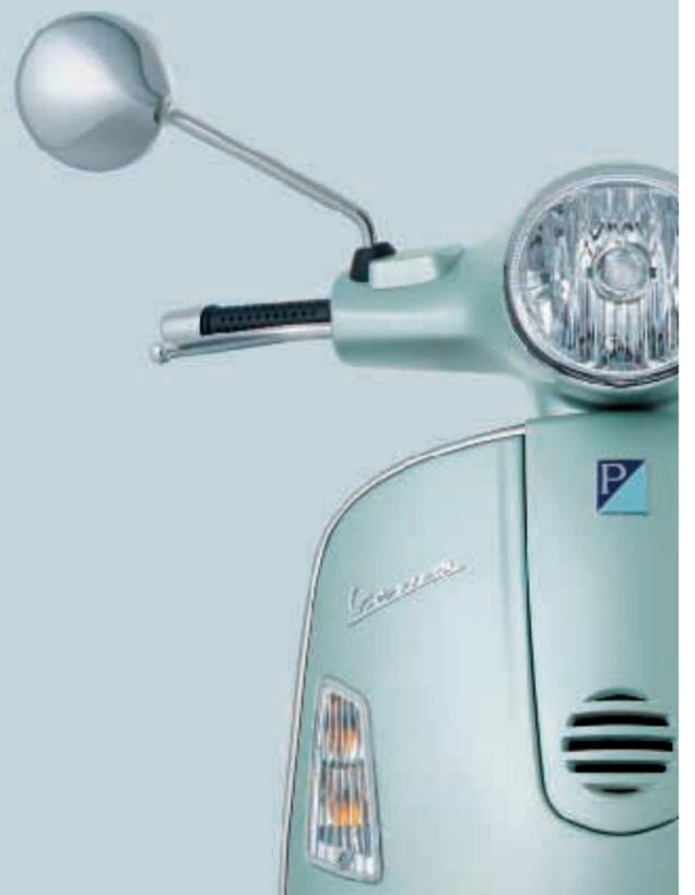
• Scocca in acciaio • Doppio freno a disco • Doppio ammortizzatore posteriore • Motore 4 tempi con raffreddamento a liquido • Ruote da 12" • Pedanine passeggero estraibili.
