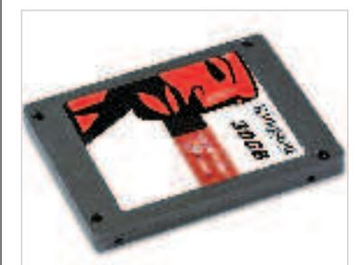
■ I nuovi drive SSD sono l'alternativa agli hard disk tradizionali perché non hanno parti meccaniche in movimento riducendo i rischi di rottura ed il calore prodotto. Kingston presenta un modello da 30 GB, SSDNow V Series, utile per l'installazione di un sistema operativo su pc.
