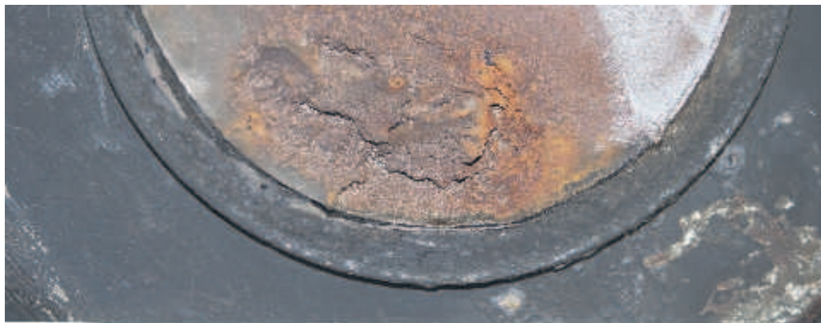
Il segno della frattura, il punto dove la «boccola» si è staccata del resto dell'asse. Anche questa piena di ruggine
