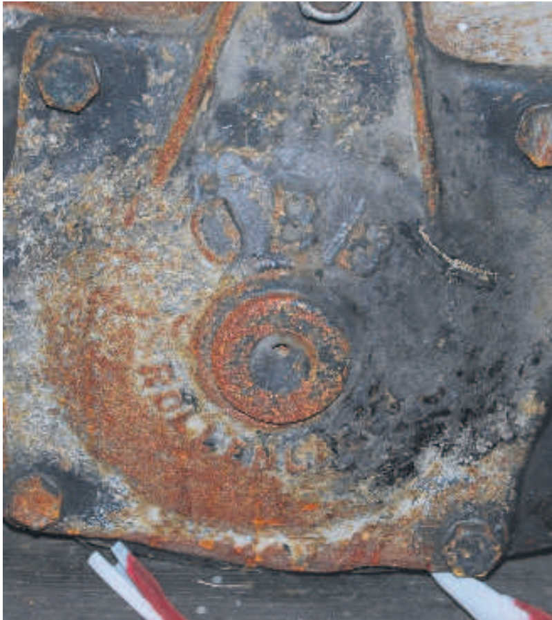
Un particolare di una delle «boccole», anche questa con ruggine
