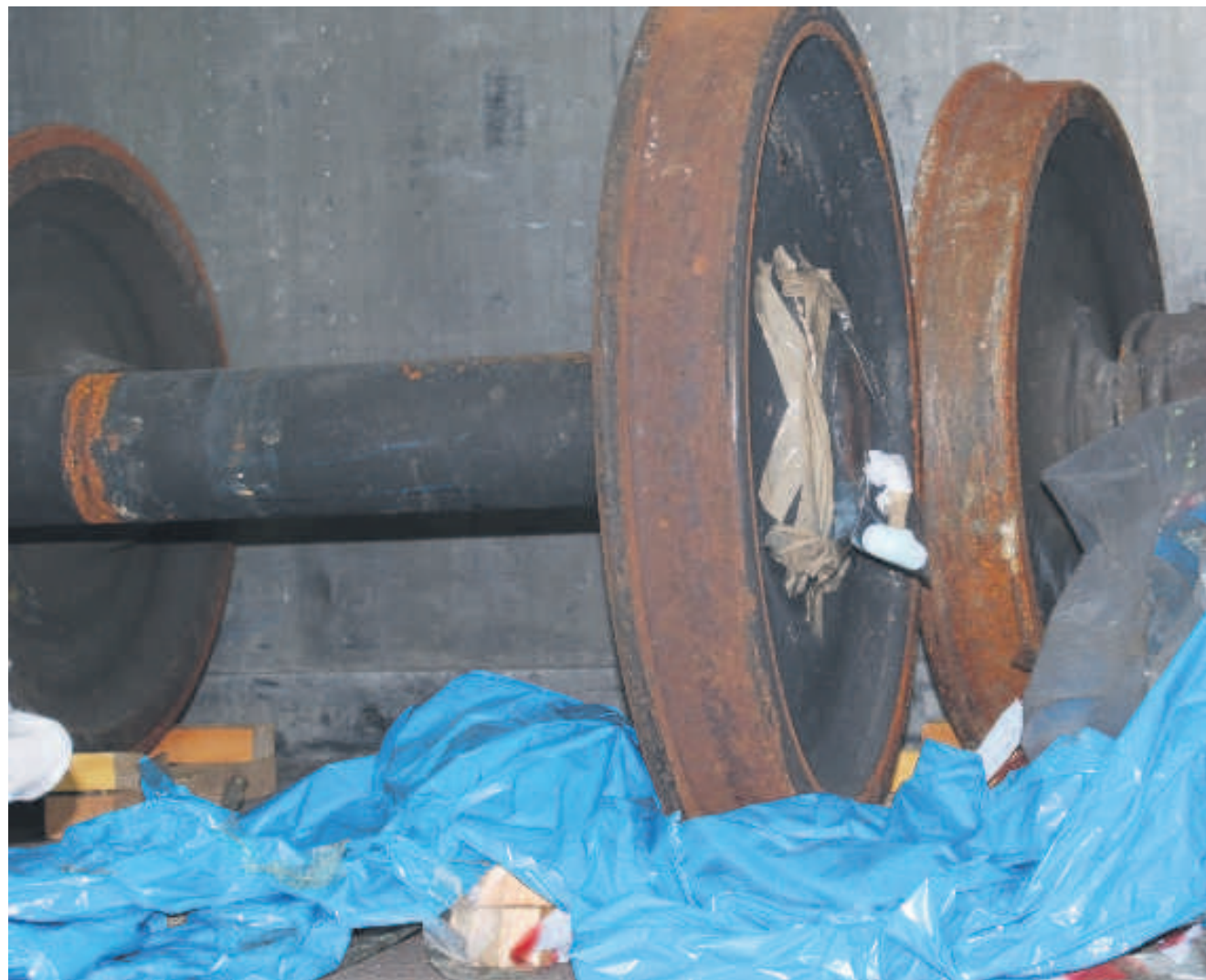
Spaccato L'asse del carrello, in gergo sala montata, privo della "boccola" pieno di «ruggine diffusa». Era stato revisionato 8 mesi prima
