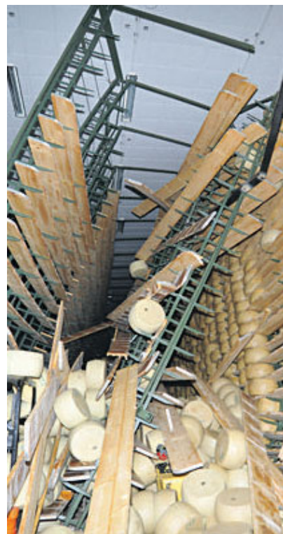
Le scalere e le forme distrutte dal sisma
