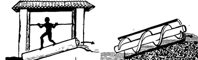
scafi delle navi o per sollevarla per l'irrigazione). Mentre la vite interna della coclea rimaneva ferma, uno schiavo faceva ruotare il cilindro con i piedi e l'acqua saliva.
