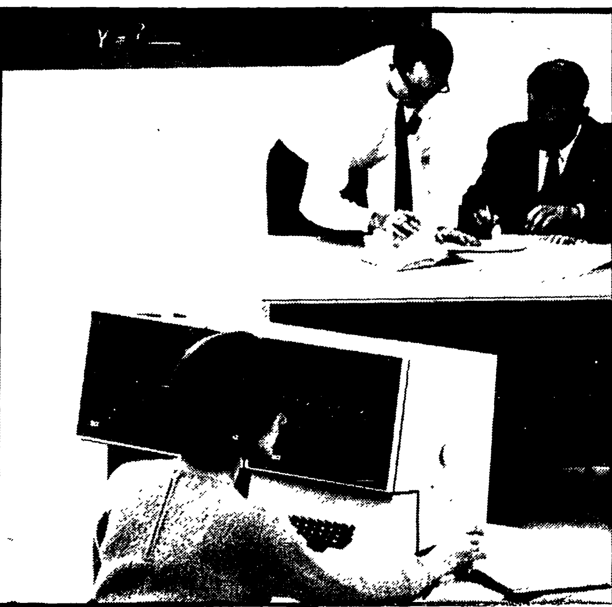
Un esempio americano di realizzazione pratica di macchina didattica. La studentessa segue un programma di matematica presentato a piccole sezioni, per permettere un processo graduale e sicuro di apprendimento, dal terminale di un computer IBM capace di collegamenti con 32 stazioni terminali. Americani e sovietici lavorano attivamente all'istruzione programmata, che potrebbe costituire lo strumento rivoluzionario per la trasformazione didattica della scuola nell'immediato futuro
