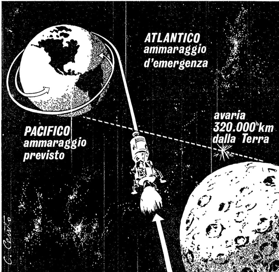
Ecco come il nostro disegnatore ha ricostruito il dramma dell'Apollo 13: modulo di servizio e di comando spinti dal motore del modulo lunare procedono verso Terra. Le zone d'ammarraggio previste sono due. La linea tratteggiata indica il punto dove si è verificata l'avaria che ha interrotto il volo per lo sbarco lunare.
