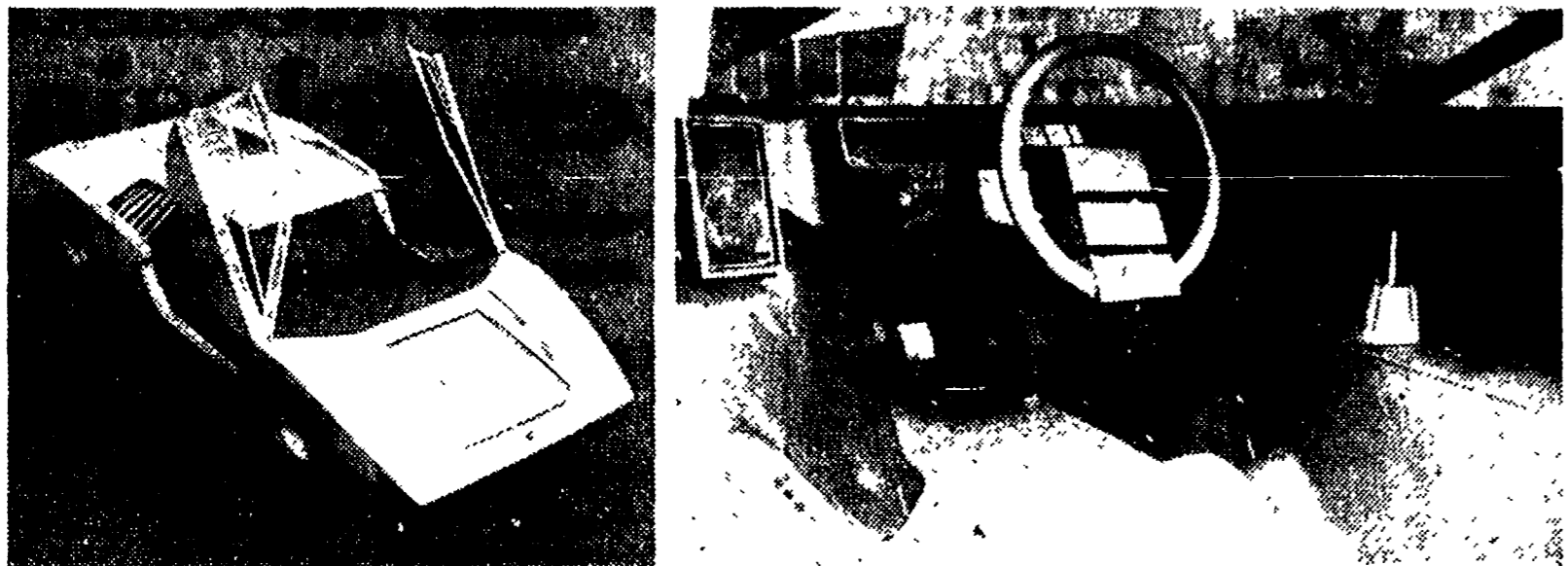
La «Countach» con le portiere aperte e, a destra, l'originale cruscotto con gli apparati di segnalazione degli eventuali guasti.
