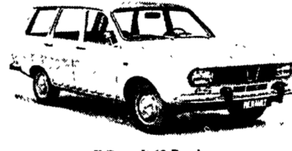
Il Renault 12 Break: 1300 cc, 145 km/h, volume di carico da 910 a 1650 dm 3
