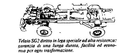
Telaio SG2 diritto in lega speciale ad alta resistenza: garanzia di una lunga durata, facilità ed economia per ogni trasformazione.
