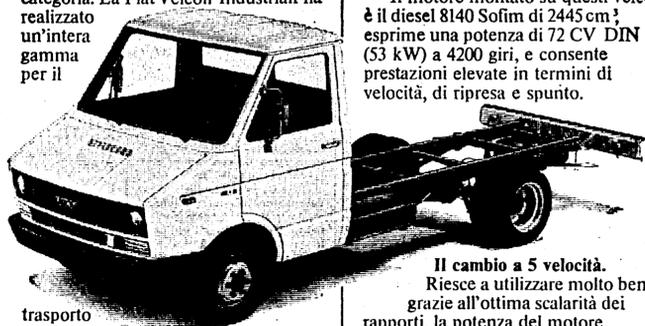
trasporto leggero e la distribuzione: autocarri, cabinati, cabina multipla, furgoni, combi, minibus, scuolabus. Piccoli, snelli e veloci, ma con un telaio a C di acciaio resistente alla corrosione e una struttura complessiva da autentico autocarro.
