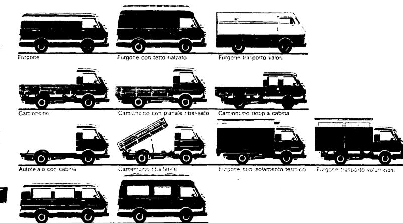
Questi sono soltanto alcuni esempi di un'ampia scelta che può soddisfare le più diverse esigenze di trasporto e inoltre propone. Tre portate utili: 12-15-18 q.li. Due passi differenti: 2500 e 2950mm per il Camioncino e l'autotelaio con cabina. Due diverse lunghezze del pianale di carico:
