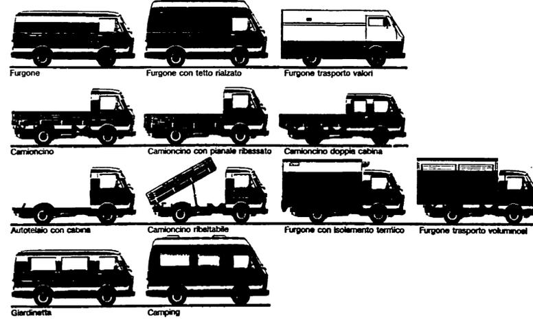
Questi sono soltanto alcuni esempi di un'ampia scelta che può soddisfare le più diverse esigenze di trasporto e inoltre propone. Tre portate utili: 12-15-18 q.li. Due passi differenti: 2500 e 2950mm per il Camioncino e l'autotelaio con cabina. Due diverse lunghezze del pianale di carico: 2990 e 3750mm per il Camioncino.
