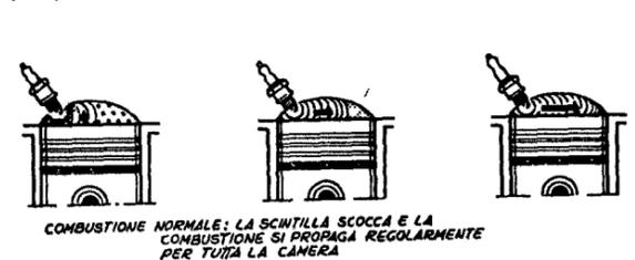
Se la miscela aria/benzina non fosse dotata di una notevole turbolenza per ottenere la combustione completa occorrerebbe un tempo assai considerevole ed il motore potrebbe funzionare solo a regimi di rotazione assai modesti e la potenza sviluppata sarebbe molto bassa.
