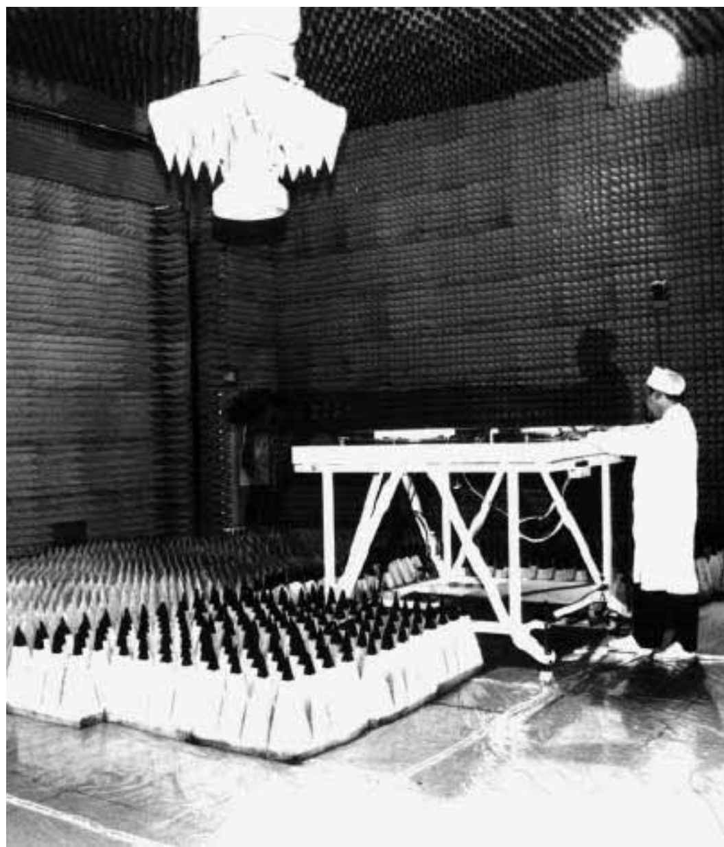
Prove di radiazione delle antenne presso il centro piccoli satelliti dell'Alenia
