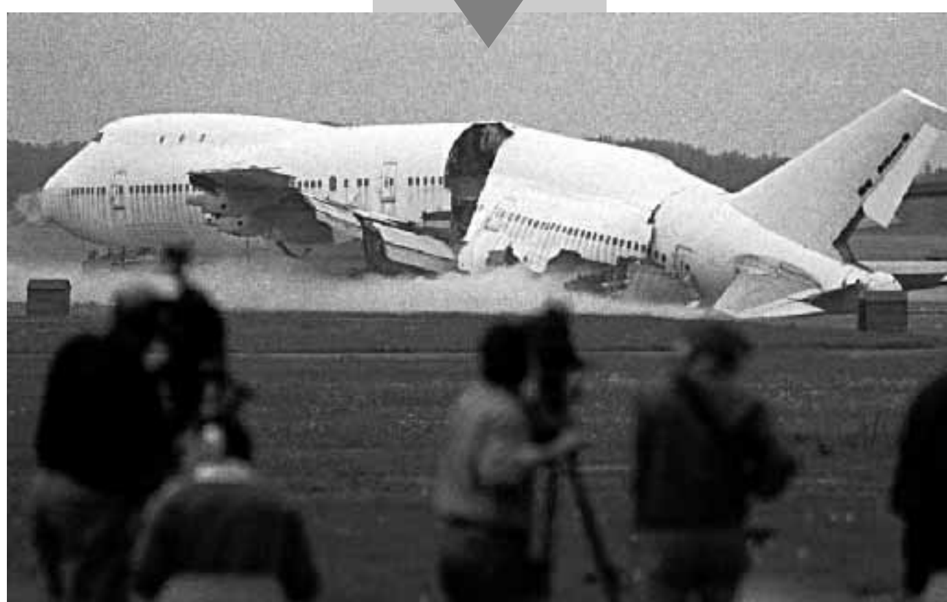
BRUNTINGTHORPE. Un Boeing 747 giace al suolo spaccato a metà dopo un'esplosione controllata, per simulare un distratto provocato da una bomba posta nel bagagliaio. I test portati a termine nella cittadina inglese di Bruntingthorpe, sponsorizzati dall'Aviazione civile britannica e dalla Federal Aviation Administration statunitense, hanno lo scopo di mettere a punto aerei più resistenti alle bombe.
