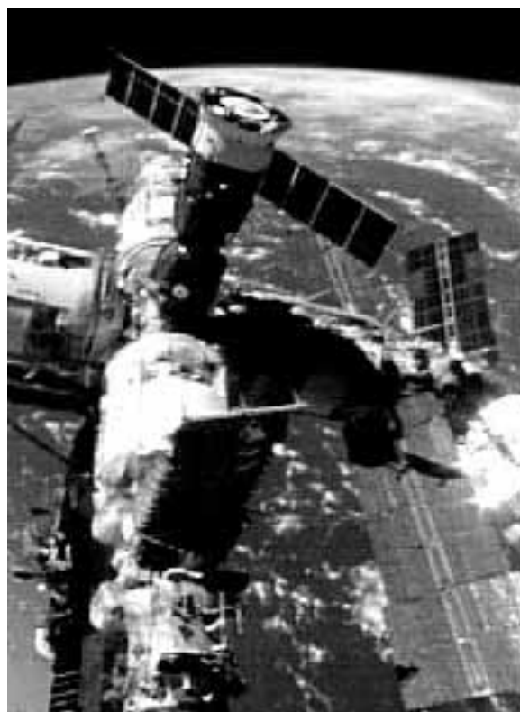
In alto, la stazione russa Mir con i pannelli solari rotti e il modulo Spektr danneggiato dallo scontro con il cargo Progress. A fianco, la Mir in orbita attorno alla Terra.
