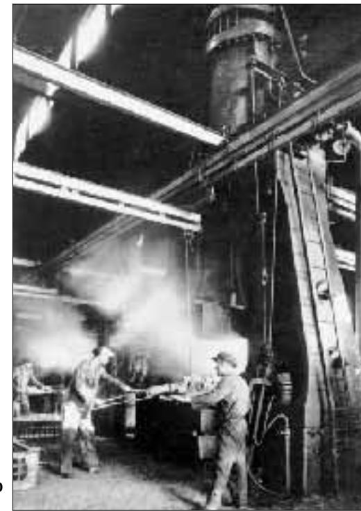
Una immagine d'epoca della Fiat 4 HP; a lato, fucinatura di un albero motore alla Fiat Lingotto; sotto la Punto
