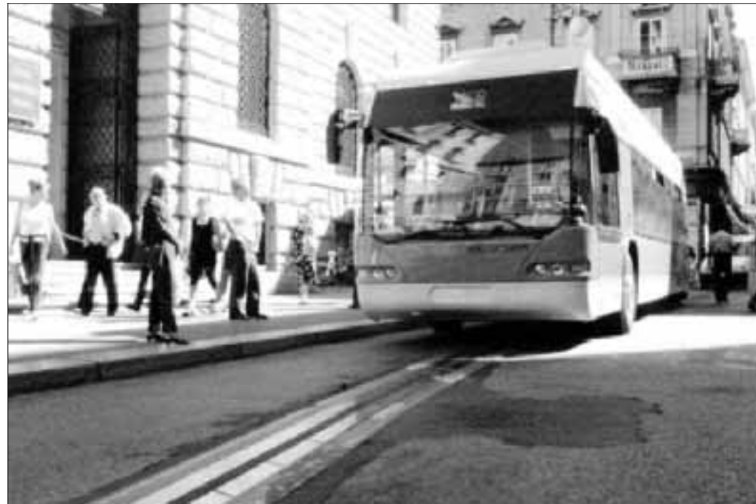
Esordio, a Trieste, dell'autobus elettrico che trae alimentazione da binari elettrici sull'asfalto
