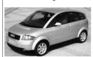
Piccola, almeno per Casa Audi, e «super-risparmiosa» in fatto di consumi è in vendita anche in Italia la A2 3L 1.2 TDI. Tradotto dalle sigle a termini più comprensibili. è la versione con motore tre cilindri di 1191 cc turbodiesel a iniezione diretta iniettore-pompa, in grado di percorrere 100 chilometri con solo tre litri di gasolio. Così equipaggiata, la A2 raggiunge la velocità massima di 168 km/h e accelera da 0 a 100 km/h in 14,8 secondi. Allo straordinario contenimento dei
