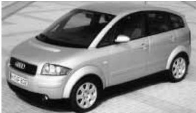
Piccola, almeno per Casa Audi, e «super-risparmiosa» in fatto di consumi è in vendita anche in Italia la A2 3L 1.2 TDI. Tradotto dalle sigle a termini più comprensibili, è la versione con motore tre cilindri di 1191 cc turbodiesel a iniezione diretta iniettori-pompa, in grado di percorrere 100 chilometri con solo tre litri di
