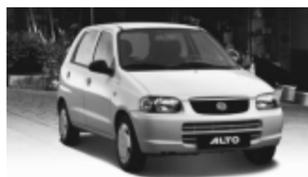
Presentata in prima europea al Salone di Ginevra (conclusosi ieri), la Suzuki Alto è la vettura ideale per chi ama la praticità e la comodità. Il nuovo motore è un quattro cilindri in linea da 1061 cc 46 kW a 6000 giri/min e una coppia di 85 Nm a 3200 giri/min vanta consumi particolarmente contenuti (4,9 litri di benzina ogni 100 km) e una notevole agilità, grazie anche a un raggio di sterzata di soli 4,6 metri. La Alto sarà messa in vendita in Italia entro l'anno.
