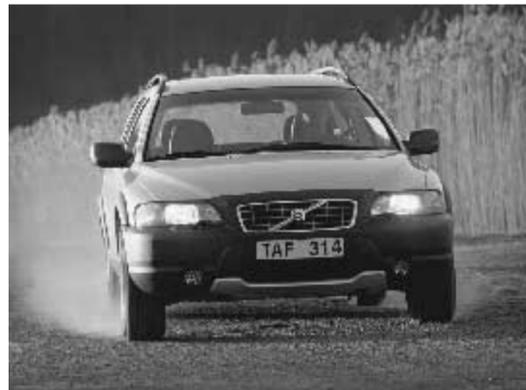
te analizzando tutta una serie di parametri per decidere, in modo automatico e ultrarapido, quanta coppia e in quali circostanze debba passare dall'asse anteriore a quello posteriore. Un rapporto che può variare dal 5 al 65% in ordine al tipo di guida, alle condizioni del fondo stradale, del regime di rotazione e del grado di slittamento di una o più ruote.
