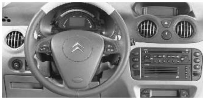
La plancia della C3 1.6 16v SensoDrive. Da dietro le razze del volante spuntano le due leve del cambio robotizzato
