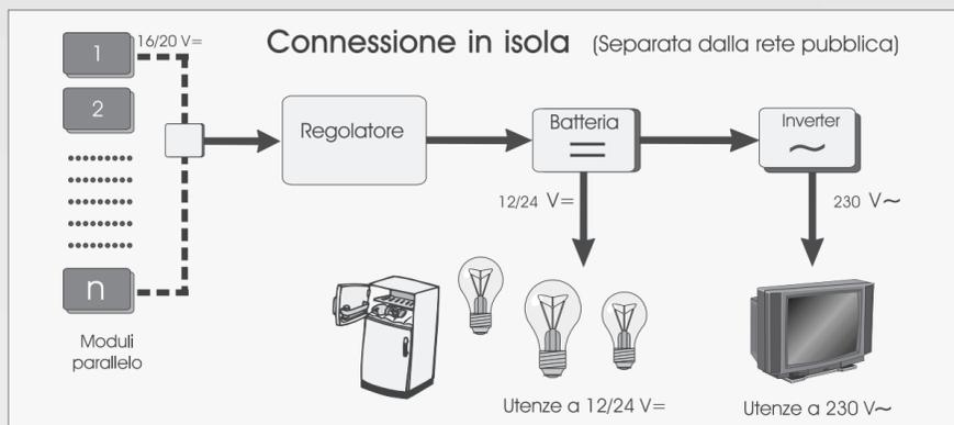
La tecnologia fotovoltaica consente di trasformare direttamente la luce solare in energia elettrica.
