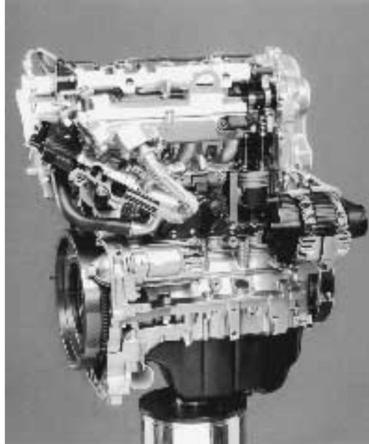
Il Multijet 1.3 16v della Fiat è già a norma Euro4 e pesa solo 130 kg. A destra, la Mazda2 in vendita il 15 marzo
