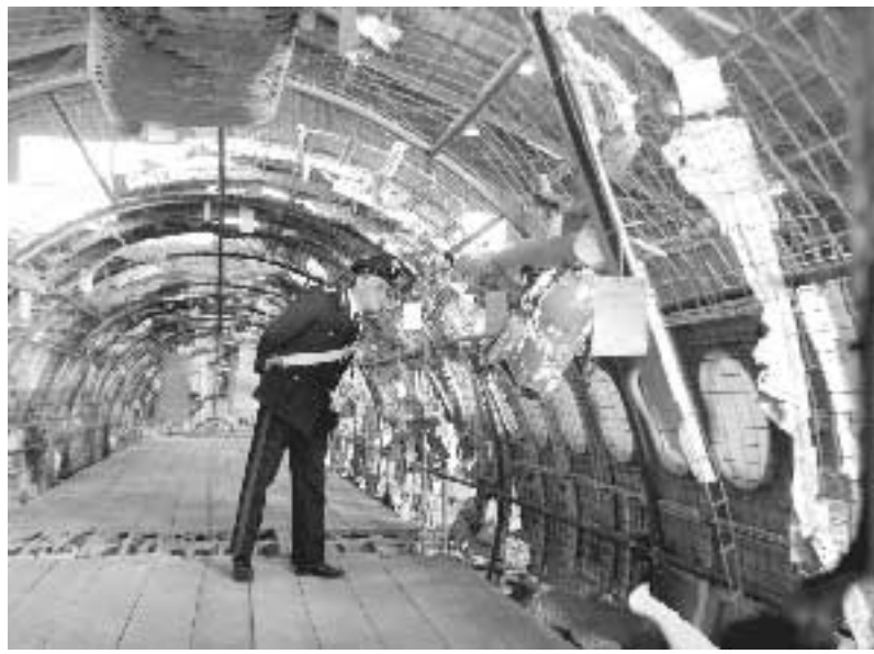
Il relitto del Dc-9 Itavia ricostruito nell'hangar di Pratica di Mare
