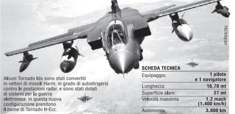
Alcuni Tornado Ids sono stati convertiti in vettori di missili Harm, in grado di autodirigersi contro le postazioni radar, e sono stati dotati di sistemi per la guerra elettronica: in questa nuova configurazione prendono il nome di Tornado It-Ecr.
