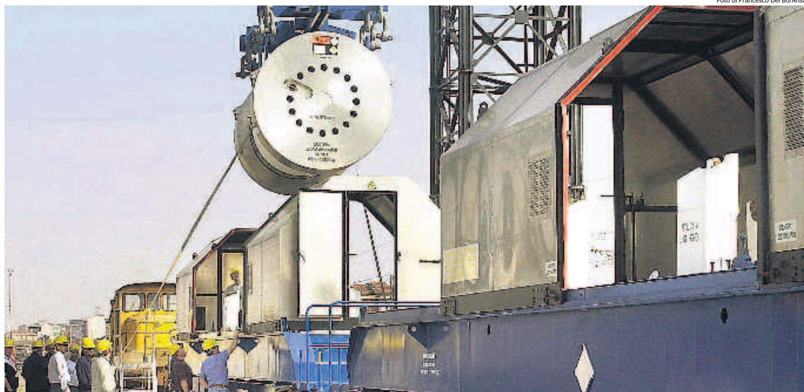
Si prepara il rivestimento anti-radioattività sui vagoni che dovranno trasportare le scorie allo scalo ferroviario di Vercelli
