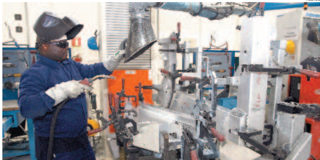
Un operaio al lavoro presso lo stabilimento Alcoa in cui vengono prodotti i telai in alluminio per la Ferrari
