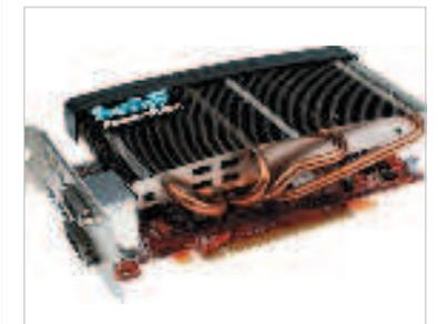
■ PowerColor propone un'interessante scheda video, basata sul "motore" Ati Radeon, che abbina prestazioni di vertice ad una silenziosità perfetta. Infatti, il modello SCS3 HD5750 non è dotato di ventola bensì di un voluminoso meccanismo di dissipazione passiva del calore.
