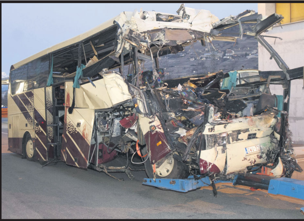
In alto e a lato lo scheletro del pullman in un hangar a fianco dell'autostrada. Il mezzo è sventrato nella parte anteriore destra e ha i pneumatici posteriori a terra
