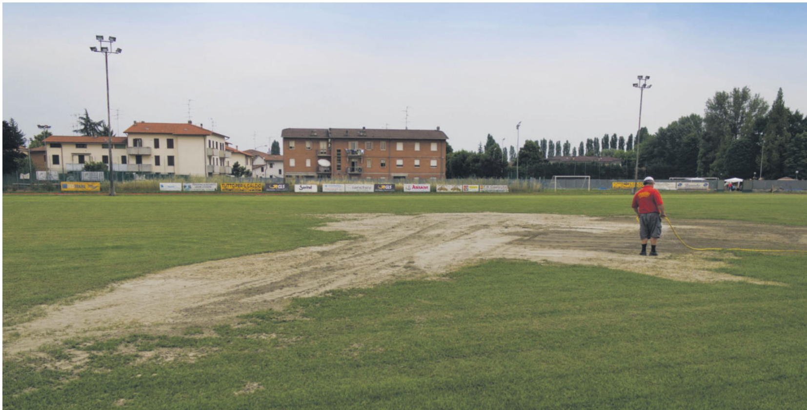
Il campo sportivo di Rivalta, in provincia di Modena, ricoperto dalle sabbie che il terremoto ha riportato in superficie
