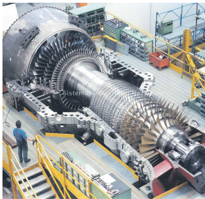
Ansaldo Energia di Genova, LAVORAZIONE DI UNA TURBINA A GAS. (ARCHIVIO FOTOGRAFICO ANSALDO ENERGIA)
